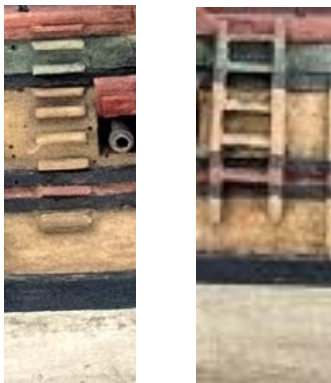
Vues des échelles de coupées tribord et bâbord, de constructions différentes - Photo de l'auteur
